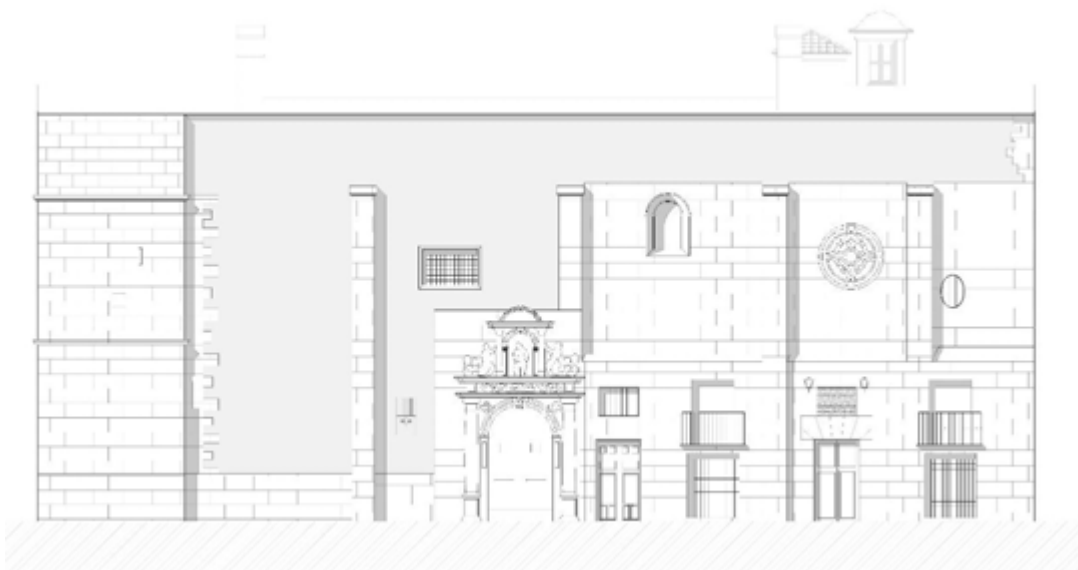
Figura 58. Alzado de la fachada sur correspondiente al muro de la epístola de la iglesia g3tica. Portada de Santa Lucía.
