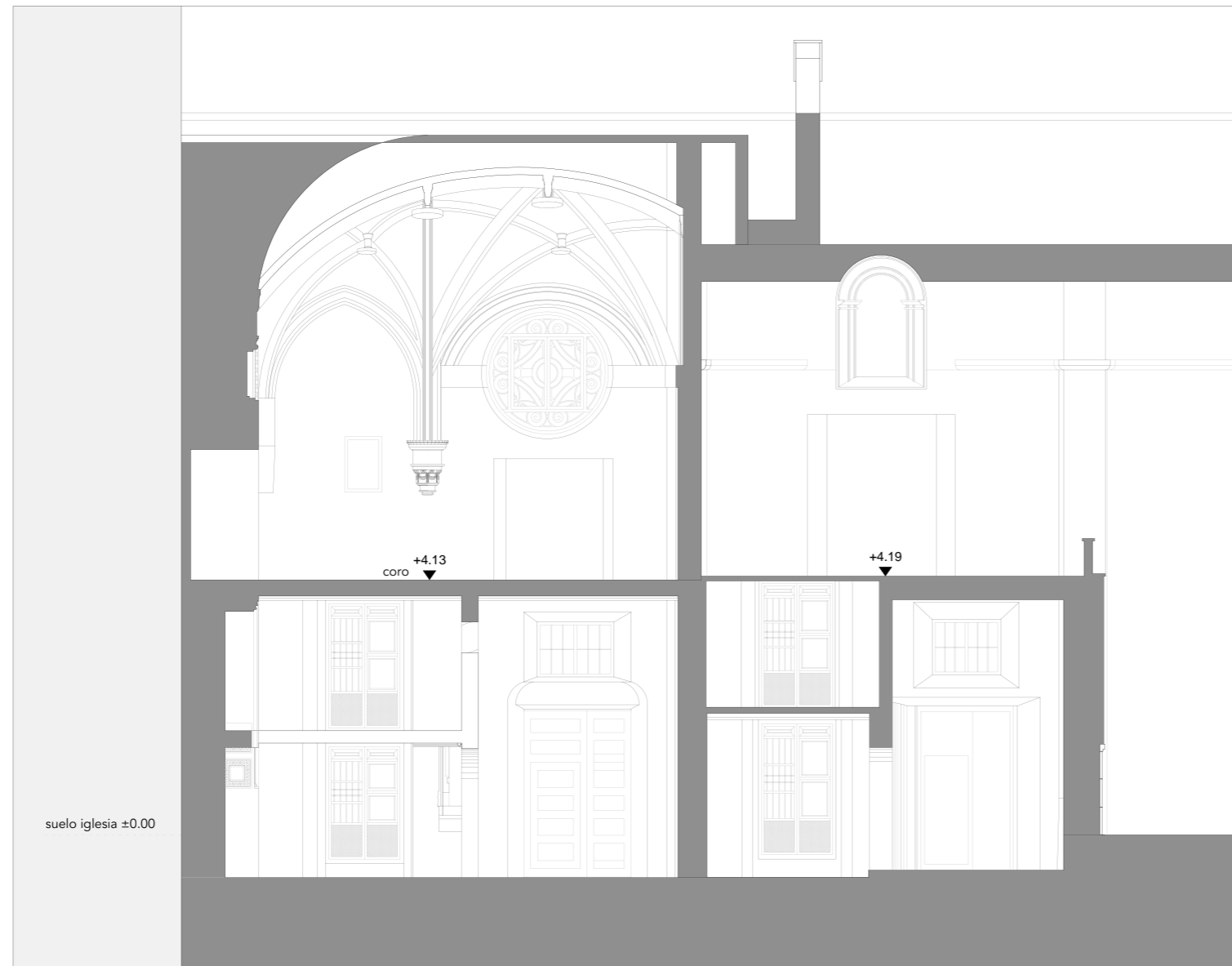
SECCION 02 | Sección longitudinal de la iglesia gótica
